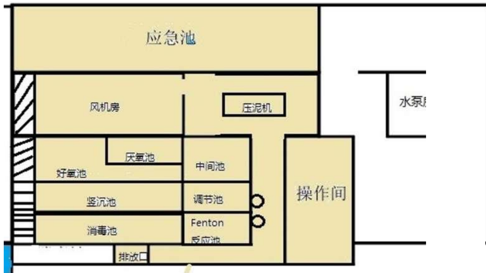
18m 3 /d 废水处理设施（TW001）平面布置图：
