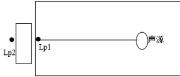
图 4-3 室内声源等效为室外声源图例
